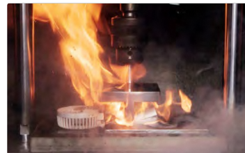
つぶされたバッテリーの 発火事故の再現
