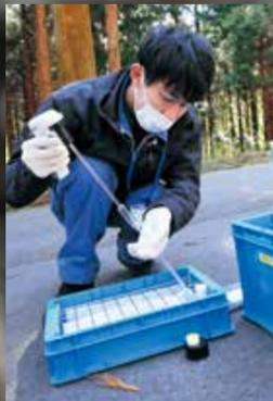
▲ラドンは空気中に拡散しやすいので、採取してすぐ山中で測定準備を施します。
