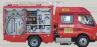
搭載したポンプで川などから消火用の水を吸水し、火災現場へ水を送水します。
