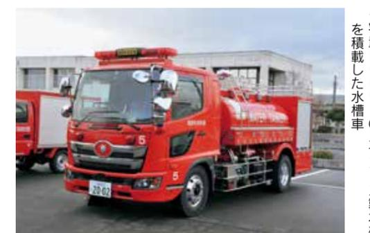
消防署に水槽車と可搬ポンプ車が導入されました。どちらの車両も小型動力ポンプを搭載しており、水槽車は高速道路や林野などの消火用の水が乏しい場所での火災時に水運搬車両として出動し、積載した水を送水するなどの活動を行います。また、可搬ポンプ車は人力で運搬できるポンプを装備し、大型の車両では進入できない場所などで活動を行うことができます。
