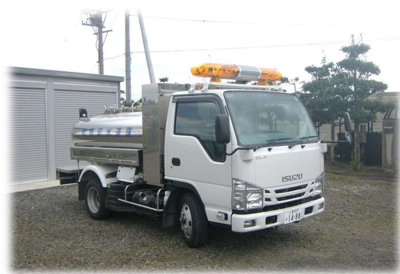
加圧給水タンク車 タンク容量2,000リットル H28年(2016年)購入
