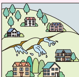
斜面から水がふき出す
